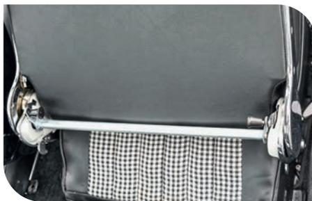
Système de verrouillage sur les châssis courts
